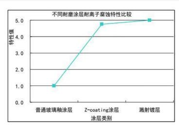
(3) Vergleich der elektrostatischen Widerstandseigenschaften Aufgrund der leitfähigen Eigenschaften von Z-Coating ist seine elektrostatische Beständigkeit deutlich höher als die von gewöhnlichen verschleißfesten Glasglasurbeschichtungen
